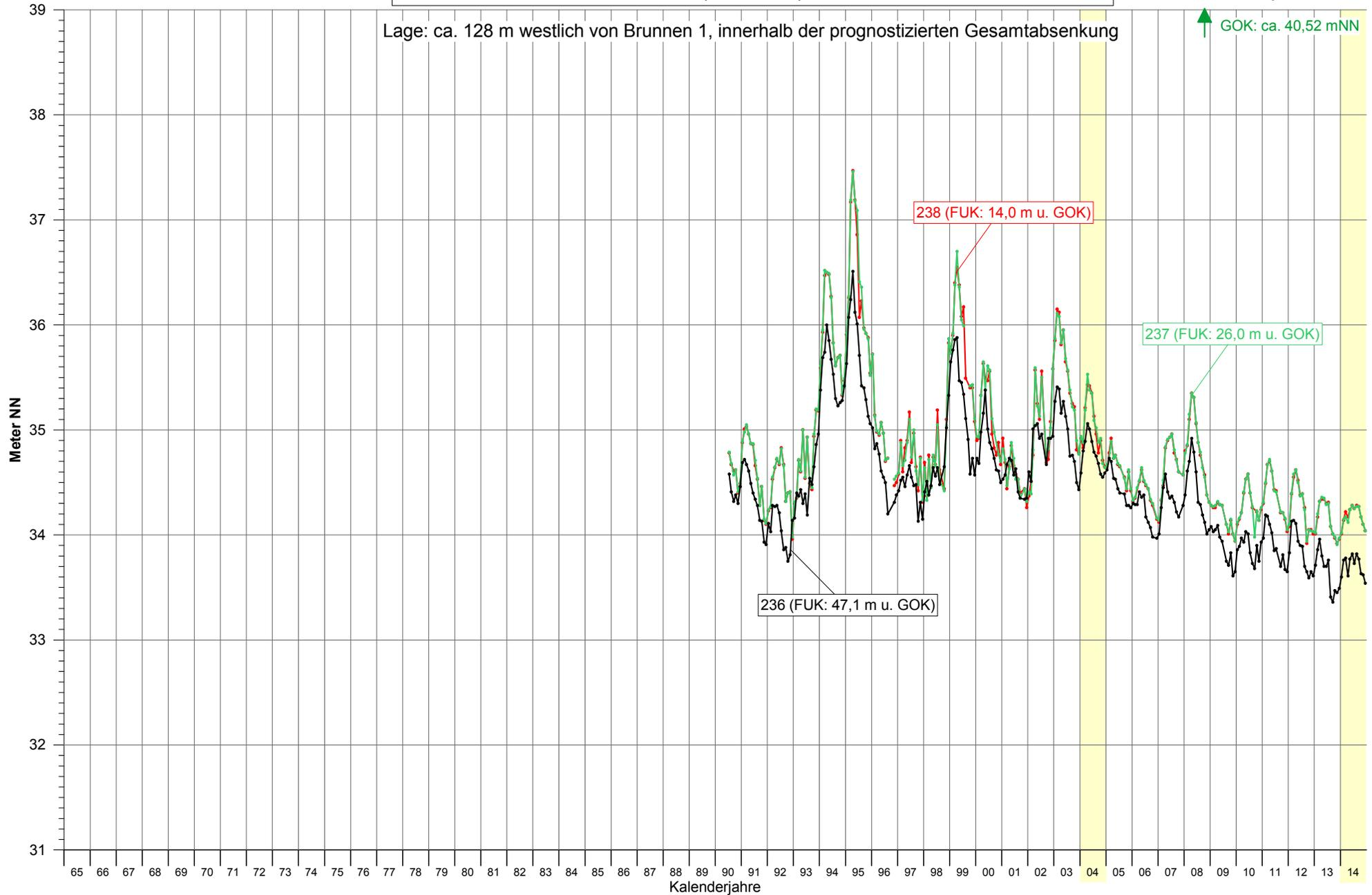
**Grundwasserstandgang an Messstelle 240**
